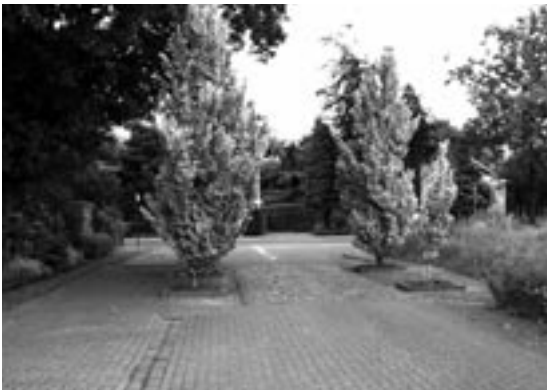
En er kan een rammelstrook in kasseitjes worden aangelegd, maar dan - anders dan hier in de Kallahoekstraat te Sint-Niklaas - boven op een verkeersplateau.
