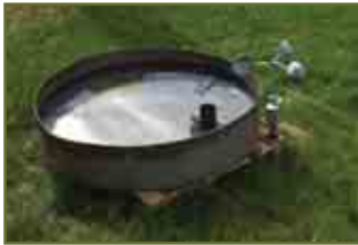
Fig. 6: Meetopstelling voor panverdamping
